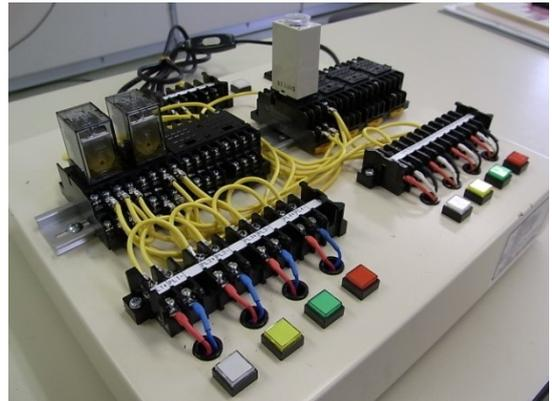
【使用機器】電磁リレー・タイマ・押しボタンスイッチ・ランプ
